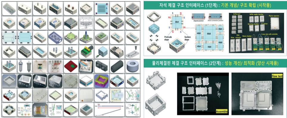
그림 6> 단위기능 모듈칩 라이브러리 구축 및 어셈블리 기술
